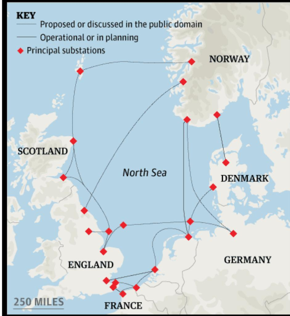
Las granjas eólicas situadas a aproximadamente a más de 90 kilómetros de un subestación onshore deberían ser conectados por cables high-voltage DC (HVDC) para reducir las pérdidas eléctricas y gastos de inversión. Las granjas eólicas situadas menos de 50 km de la red de transmisión onshore serán conectados por cables high-voltage AC (HVAC). En el rango intermedio, la elección de la tecnología AC o DC dependerá de los parámetros de los proyectos específicos.
